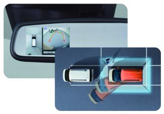
真上から見下ろしているような映像をルームミラー内のモニターに表示するマルチアラウンドモニター (移動物検知機能付)。運転席から視認しにくい左前方や車両後方など周囲の安全をしっかり確認しながら駐車を行うことができます。
